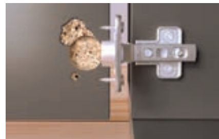
Reparatur ausgerissener Scharniere
