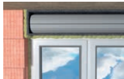
Anschlussfugen um Rolladenkästen
